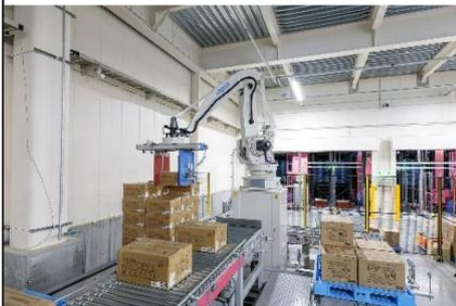
\*大型物料處理設備(如機器人堆棧機、全自動紙箱切割機等)提升效率化與人力節省
