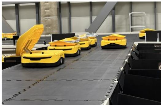
t-Sort 是物流作業中很彈性且靈活分類的 AGV，對於現場物流從業人員來說也易於操作；這一個小機器人，正在顛覆及改變倉庫作業，真正達到智慧物流的元素。t-Sort 中的「t」代表「表格」，只需將 PVC 片鋪設在擬作業的場域，然後架放置在地板上的棧板或鋼架上即可運作。不論空間多大或狹小密閉空間
